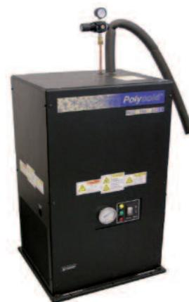
Pour compléter l'investissement d'une DMA 50 ACOEM Metravib sur son site de Carquefou, l'IFOCA a fait l'acquisition d'un refroidisseur d'air – sécheur d'air AIR CHILLER permettant de mener des essais jusqu'à -70°C sans aucun recours à l'azote liquide. Ce dispositif permettra aux étudiants et stagiaires de réaliser des essais de caractérisations viscoélastiques sur une gamme de température élargie représentative des applications industrielles.
